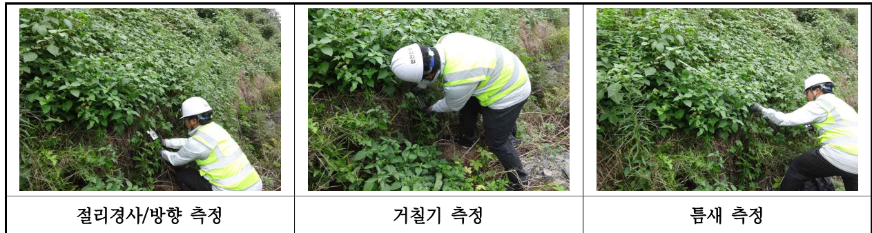
【그림 39.3.5】 불연속면 측정 현황
